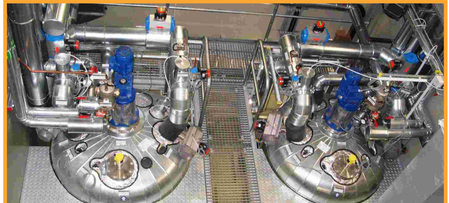
SteriFix C 2500 , Leistung 12 m 3 /Tag, bei 134°C und 20 min Verweilzeit
