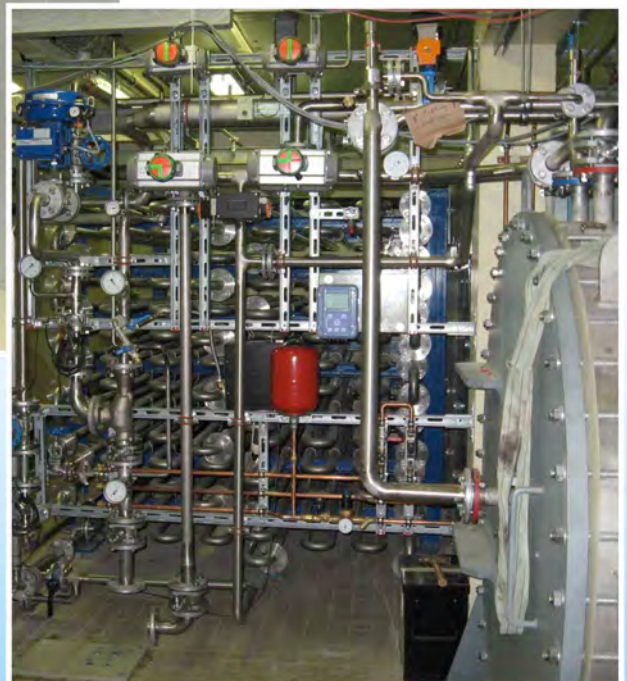
Geöffnete Verweilstufen 3 m 3 /h, 121°C, 20 min. Inst. CIDC, Uni Wageningen, Lelystad, NL
