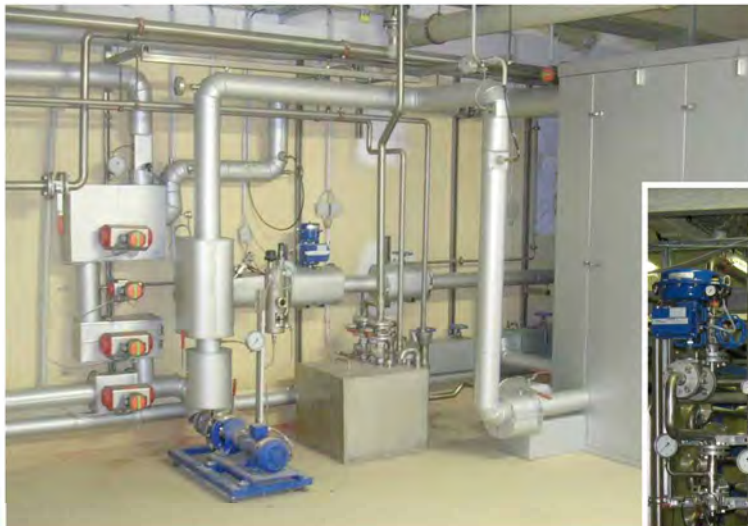
Verweilstufen 3 m 3 /h, 121°C, 20 min. Inst. CODA, Machelen, Belgien
