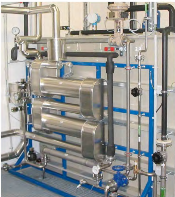
Rohrbündel-Wärmetauscher mit 1,2m 3 /h
