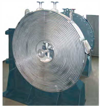
Geöffneter Spiralwärmetauscher für stark feststoffhaltige Abwässer (Impfstoffwerk, Lelystad, NL)
